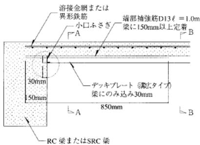
図2 デッキプレート長手方向の納まり
